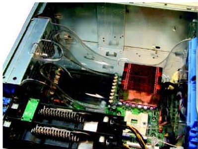
▲ 特別設計的導風罩，有效冷卻處理器與其它組件。
