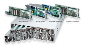
SYS-5038MD-H8TRF (XeonD) SYS-5039MS-H8TRF (Skylake) SYS-5038ML-H8TRF/OEM (Haswell) SYS-5038MR-H8TRF (Broadwell)
